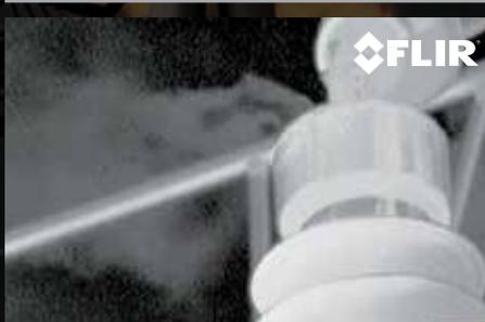
SF<sub>6</sub> LEAKING FROM CIRCUIT BREAKER
